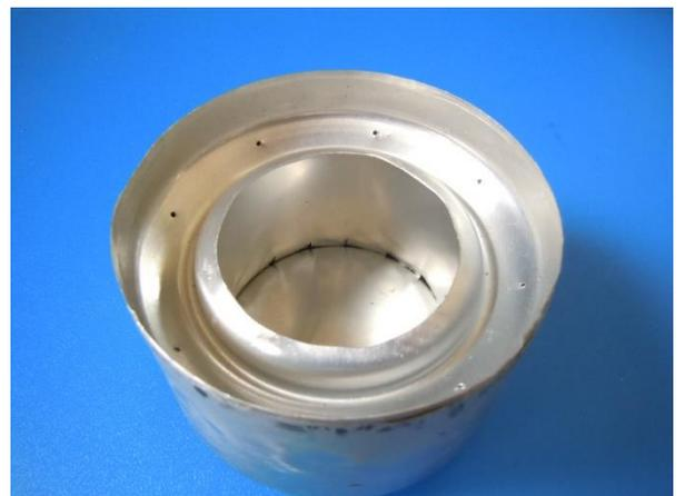
部材の組み合わせは、副室の上部が密閉されるようにすることがポイントです。熱せられて、ここで気化したアルコールが噴出孔から吹き出し強力な火力を生み出します。作業は手を切りやすいので十分ご注意ください。
