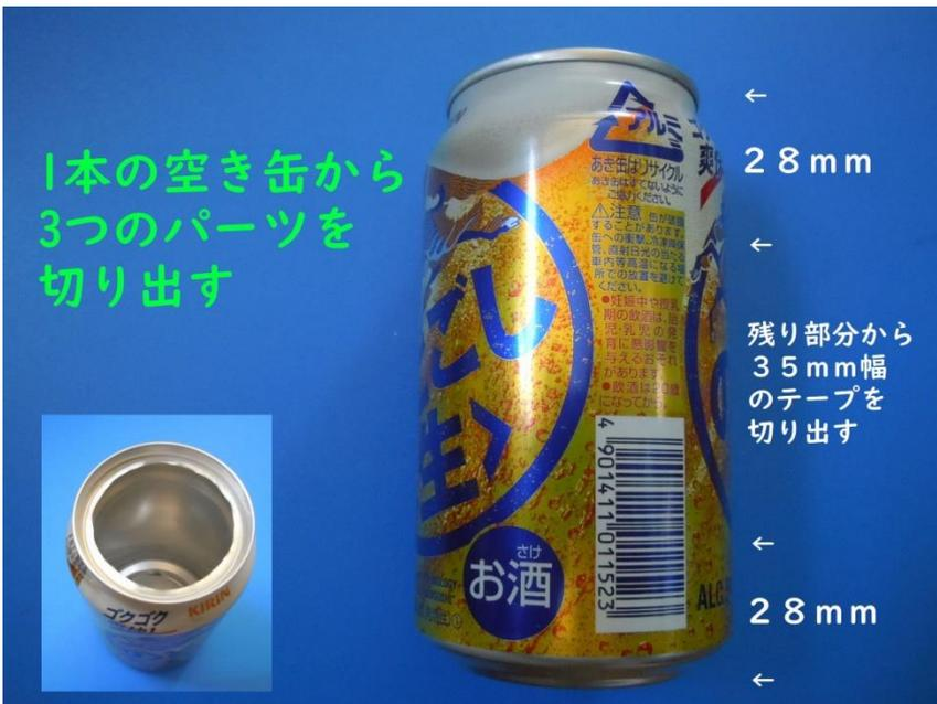
空き缶から3つの部品を切り出します。予め上の蓋の部分は切り取っておきます。所定の長さで上の部分と底の部分を切り取ります。残りの部分から副室を作るためのテープを切り出します。
